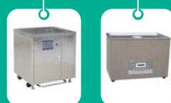
医用超声波清洗机工作频率一般在**20~40kHz**，每个换能器的功率一般在50瓦左右，这样可以最大限度的保护被清洗的医疗器械少受损伤，可以彻底清洗手术器械及手术附件的餐种污渍，解决人工清洗不彻底的问题，同时保护工作人员免受污染和感染，是医院消毒供应中心的必备设备之一。
